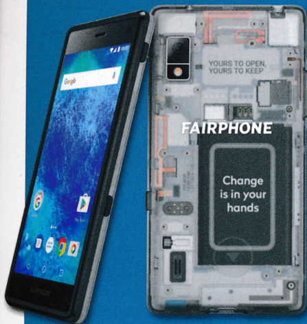
Das neue Fairphone II – auswechselbare Module für alle Fälle
